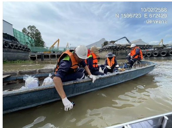
การเก็บตัวอย่างน้ำผิวดินสำหรับวิเคราะห์ Oil&Grease โดยเก็บที่ผิวน้ำ
